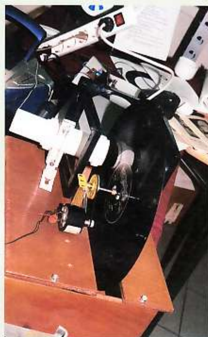
Dat er met eenvoudige middelen ook wel iets te bereiken valt toont deze foto. Voor de gaatjes-schijf is een grammofoonplaat gebruikt en voor de aandrijving een motortje uit een cassetterecorder. Die goeie oude Mecanno-doos komt weer goed van pas. In het witte omhulsel is een moderne fotocel ondergebracht.
